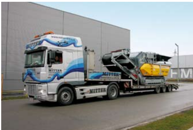
1 Transportation of the RM100 by low-loading truck Transport des RM100 mit dem Tieflader
